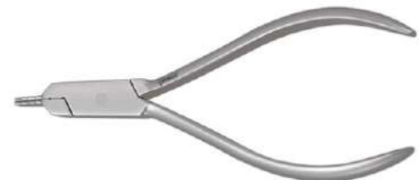
DO.688.300 Nance Loop forming pliers Four steps beak for making precision loops of 3, 4, 5 or 6 mm in round or rectangular wires. One tip is serrated to prevent wire slippage Pinza per formare le anse Le punte con quattro gradini consentono di realizzare con precisione anse di 3, 4, 5, o 6 mm sia con fili a sezione tonda che quadrangolare. Una delle due punte è zigrinata per evitare che il filo scivoli.
