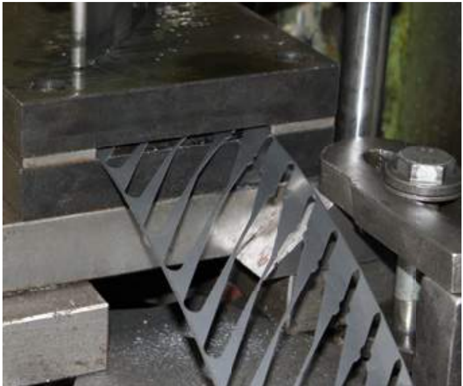
Cutting the spatulas from a stainless steel sheet. Tranciatura delle spatole da un nastro di acciaio.
